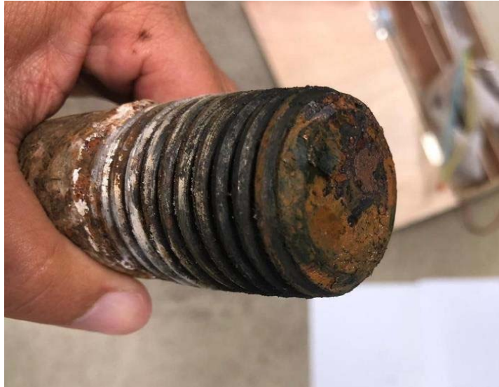
圖 3-8 生鏽的螺紋鋼筋
